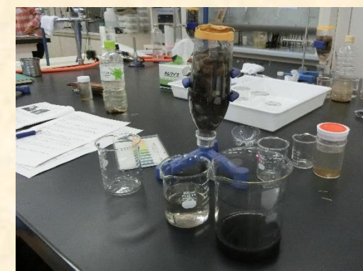
▲ペットボトルと炭や砂、小石などを使った水の浄化実験
